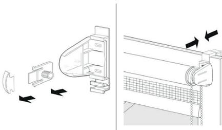
Разбираем один из кронштейнов (1). Соединяем элемент разобранного кронштейна (1) с втулкой (3).
