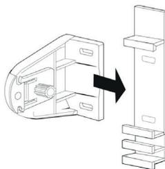
Закрепляем кронштейны (1) на фиксаторы (2).
