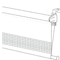
Помещаем утяжелитель (7) в нижний «карман» полотна шторы.
