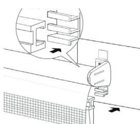
Заворачиваем полотно ткани с каркасным профилем (5) и вставляем его в фиксатор (2).
