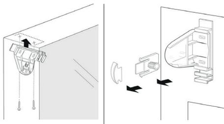
Снимаем со шторы кронштейны (1) с фиксаторами (2) и крепим их к створке / стене / потолку при помощи саморезов (в комплект не входят).
