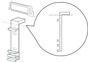
Удаляем верхнюю часть фиксатора (2) при помощи ножовки или кусачек.
