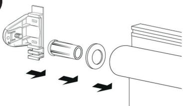
Собираем штору целиком для точной разметки отверстий на створке / стене / потолке. Надеваем на втулку (3) ограничительное кольцо (4) и вставляем в трубу рулонной шторы (6). Соединяем кронштейн (1) с втулкой (3).
