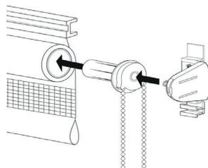
Надеваем на цепочный механизм (8) ограничительное кольцо (4) и вставляем в трубу рулонной шторы (6). Соединяем кронштейн (1) с цепочным механизмом (8).
