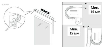
Делаем точную разметку на створке / стене / потолке при помощи пузырькового уровня.
