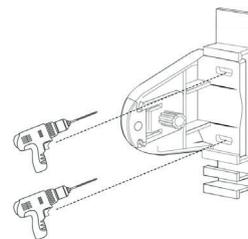
Сверлим в кронштейнах (1) с фиксаторами (2) отверстия диаметром 3-6 мм.
