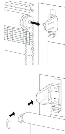
Устанавливаем рулонную штору на кронштейны (1), прикрепленные к створке / стене / потолку. Сначала устанавливаем цепочный механизм (8) на неразобранный кронштейн (1) с одной стороны. Потом фиксируем штору с другой стороны - при помощи деталей разобранного кронштейна (1).
